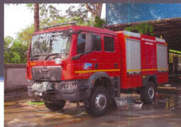
รถดับเพลิงพร้อมระบบผสมโฟม STRUCTURAL FIRE FIGHTING VEHICLE
